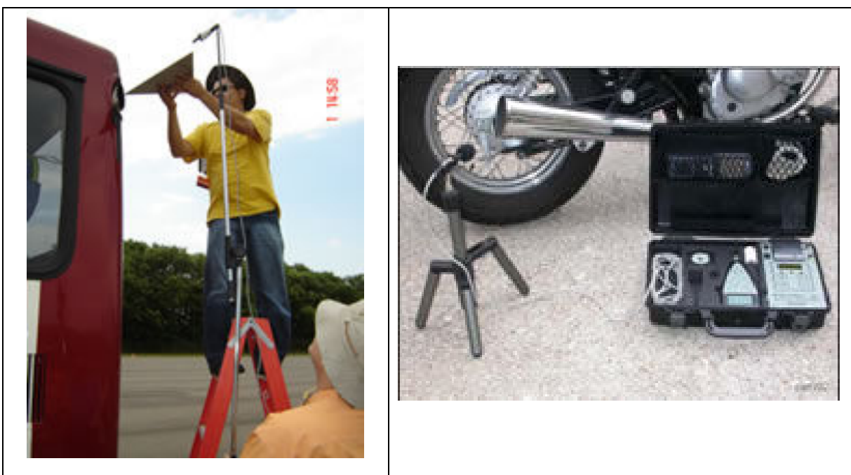
Figura 2.5.1 - Ensaio de diferentes tipos de veículos parados conforme NORMA NBR 9714
